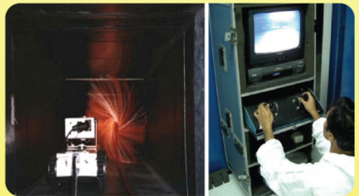
ชุดเครื่องมือทำความสะอาดด้วย ระบบคอมพิวเตอร์และหุ่นยนต์อัตโนมัติ
