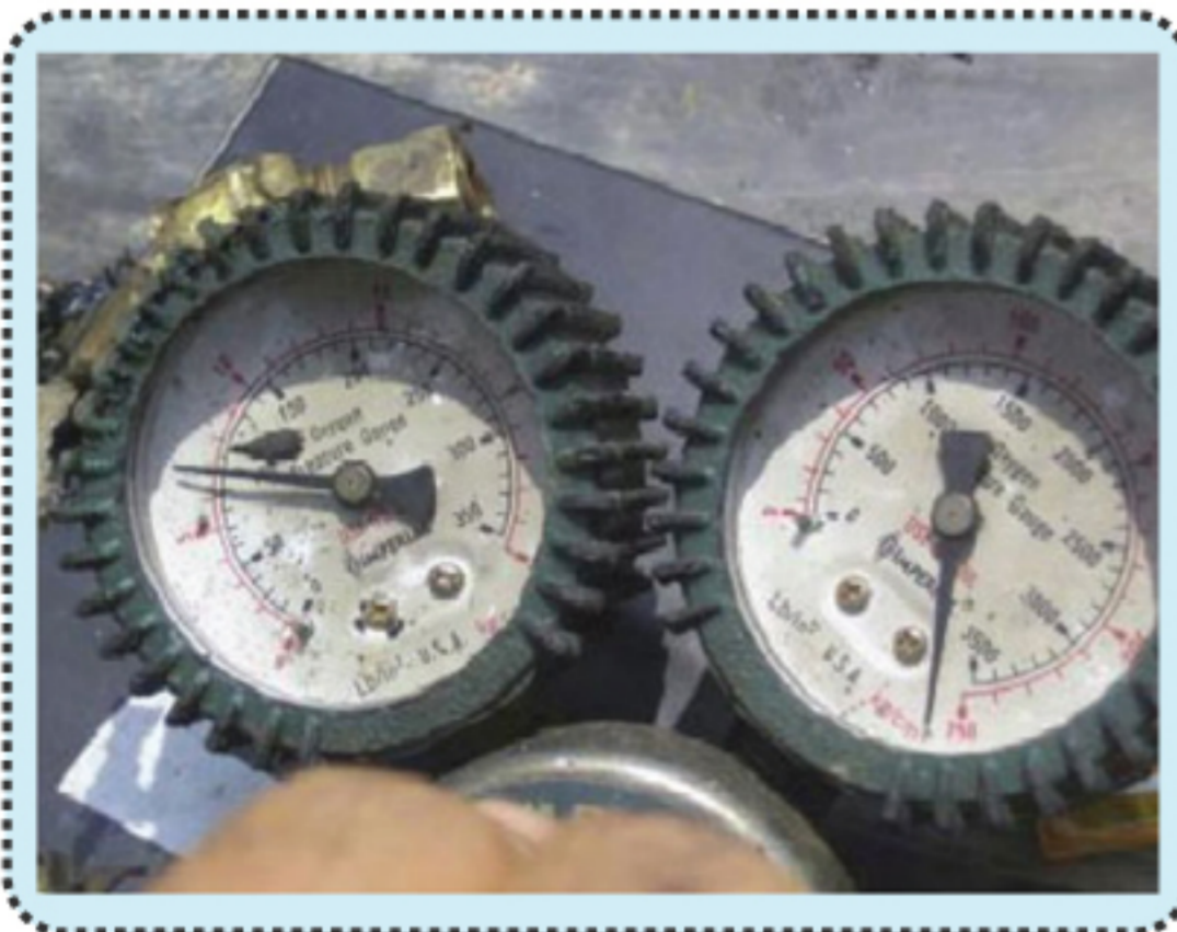
สภาพ Regulator ของถังออกซิเจน สังเกตเข็มของเกจวัดความดัน ตีกลับจนสุดเกจเนื่องจากแรงระเบิด
