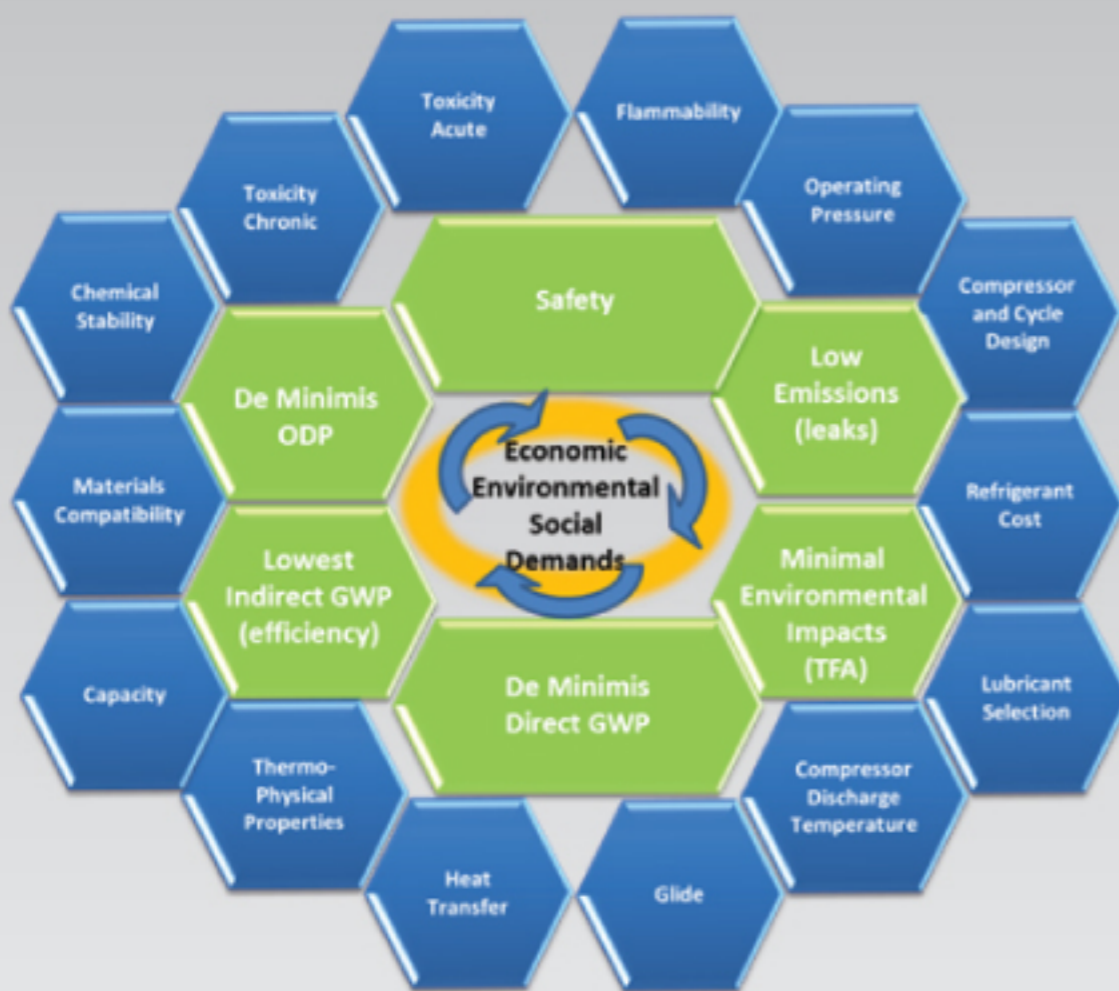
รูปที่ 10 – ปัจจัยการพิจารณาสารทำความเย็นทางเลือก โดยผู้ผลิตเครื่องปรับอากาศชั้นนำรายหนึ่งจากสหรัฐอเมริกา
